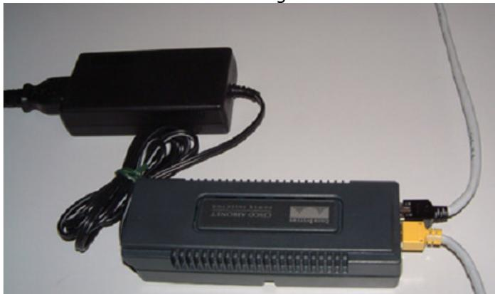
Strom und Ethernet gebündelt gehen danach zusammen über ein Kabel zum. Dieses kann am Access Point angebracht werden. Dieser läuft dann ohne Problem mit dieser Option.
