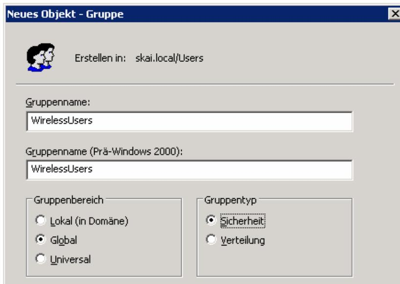
In diese Gruppe müssen alle Computer und User hinzugefügt werden die auf das WLAN Zugriff haben sollen. Sie werden dadurch authentifiziert.
